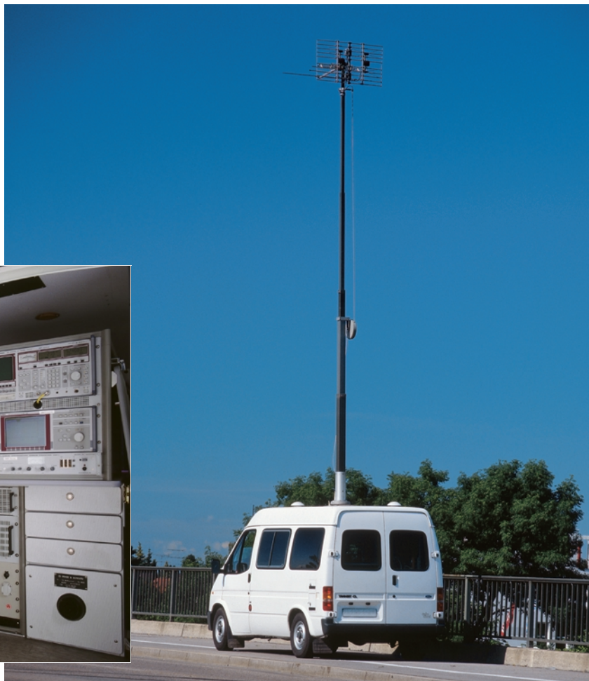
Messfahrzeug mit Versorgungsmesssystem R&S ARGUS-FMTV
